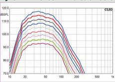
Satte 1000 Watt stehen dem Arendal-Subwoofer 3 zur Verfügung, die er effektiv in Schalldruck umsetzen kann. Kompressionsfreie Wiedergabe bis 25 Hertz ist selbst bei Pegeln von 115 dB (0,5 Meter) kein Problem.
