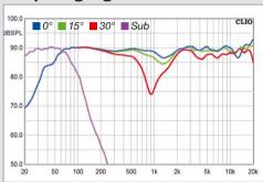
Abgesehen von einem leichten Einbruch bei 30° zeigt der Arendal Center ein 100 % praxistaugliches Verhalten - denn auf Achse und bei 15° spielt de Center perfekt. Der Subwoofer erweitert das Frequenzspektrum druckvoll bis ca. 25
