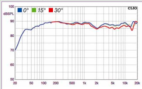
Die Abweichungen vom Ideal liegen selbst unter Winkeln von 30° bei maximal -3 dB. Die untere Grenzfrequenz der 1723 Monitor S liegt bei etwa 40 Hertz, allerdings fällt der Pegel der kompakten Lautsprecher schon bei 100 Hertz zu tiefen Frequenzen ein wenig ab.
