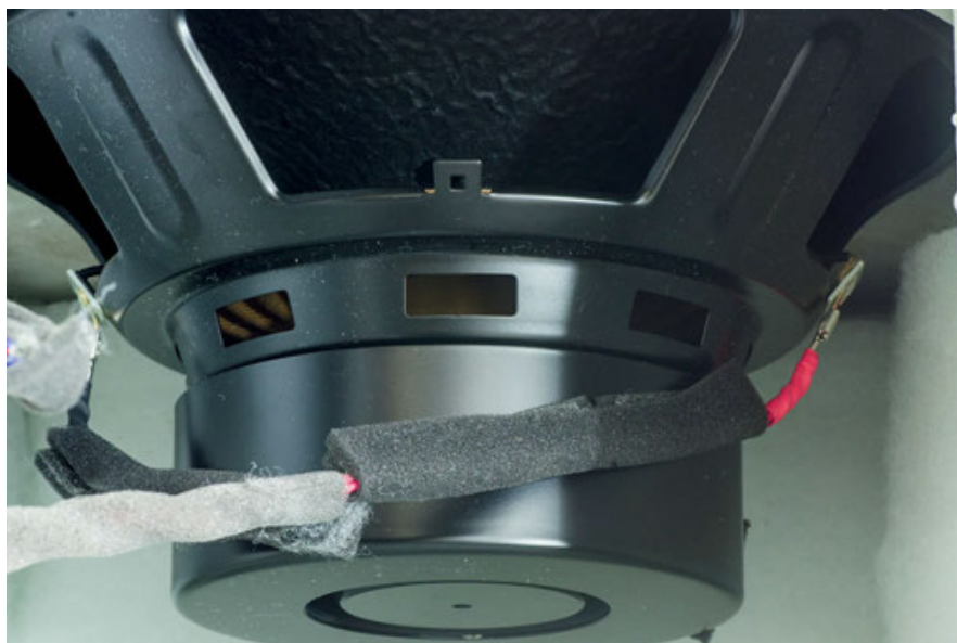
dv Il grosso woofer da 35 centimetri utilizza una membrana in polpa di cellulosa rinforzata con fibra di vetro. La schermatura del magnete è resa necessaria per ottemperare alle normative sul campo magnetico relative al trasporto.
