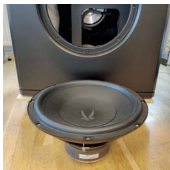
Åtta maskingängade skruvar håller elementet, och det är sjukt bra att ha riktiga gängor i lådan, både av service- och underhållsskäl.
