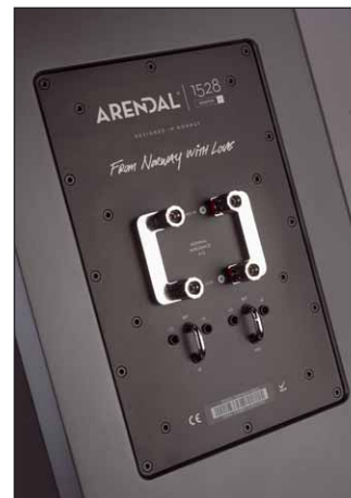
Hier noch einmal im Detail die massiven rhodinierten Biwiring-Brücken. Mittel- und Hochtöner können jeweils in drei Stufen im Pegel angepasst werden
