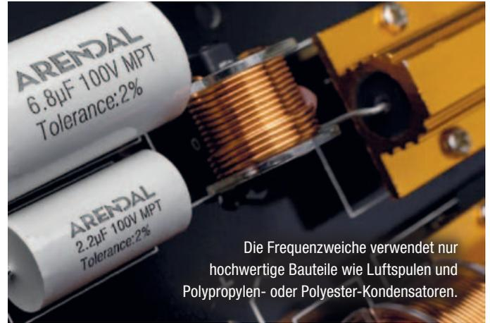
Die Frequenzweiche verwendet nur hochwertige Bauteile wie Luftspulen und Polypropylen- oder Polyester-Kondensatoren.
