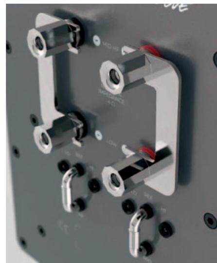
Trotz der polierten Oberfläche lassen sich die rhodinierten Kupferklemmen gut festdrehen. Unter den dicken Brücken befinden sich die zwei Jumper zur Anpassung von Höhen und Mitten, jeweils in drei Stufen von  $-2$  dB bis  $+2$  dB.
