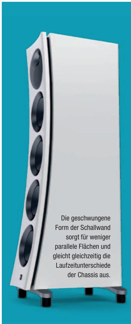
Die geschwungene Form der Schallwand sorgt für weniger parallele Flächen und gleicht gleichzeitig die Laufzeitunterschiede der Chassis aus.
